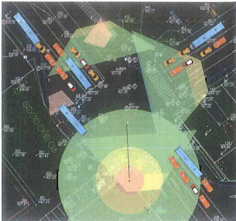
Fig. 3.2. Poziționare camere intersecția 1
